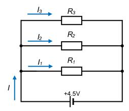
Der Gesamtwiderstand einer Parallelschaltung berechnet sich zu:
