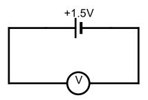
Somit kennst du also schon die Schaltzeichen für Batterie (langer Strich ist Plus) und für ein Spannungsmessgerät, auch Voltmeter genannt. Die Mignon-Batterie hat also eine Spannung von 1,5 V.
