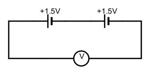
Offensichtlich misst du als Gesamtspannung beider in Reihe geschalteten Batterien die Summe beider Teilspannungen: 1.5 V + 1.5 V = 3 V.
