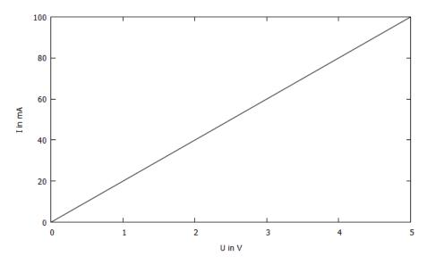
Der Widerstand hat eine lineare Strom-Spannungs-Kennlinie. Verdoppelt man die Spannung, verdoppelt sich auch die Stromstärke.
