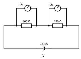
Die Maschenregel besagt, dass die Gesamtspannung U gleich der Summer der Teilspannungen  $U_1$  Und  $U_2$  beträgt:
